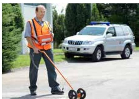
Im Zuge der routinemäßigen Wartung des Gasnetzes wird die Leitungstrasse mit einem Gasspürgerät abgegangen und auf Funktionalität geprüft.
